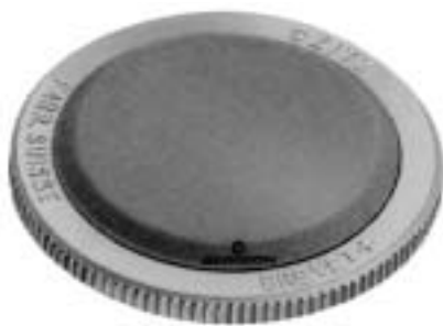
Abb. 116: Nur bei Verwendung dieses Spezialsteines können alle Flachpunzen berichtigt oder nachbearbeitet werden (ebenfalls verwendbar zum Nachschleifen der Einsätze des Steineinpressapparates Seitz)
